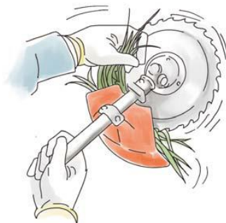
詰まった草を除去する際は、エンジンを必ず切る！
