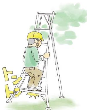
設置する際、最下段のステップに乗って“トントン”と踏み込む
