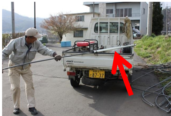
②軽トラなどに一回り太い鉄パイプを固定し、中に通しながら曲がった部分を直していきます。力はあまり必要ありません。
