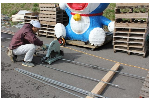
③手ごろな長さに切断し、切断口は危ないのでやすりなどで削ります。支柱に用いる場合は片側をハンマーで潰すと畑で刺さりやすくなります。
